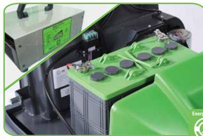
Vano batterie estremamente ampio. Disponibile con batterie al Gel **Power Battery**, che non richiedono manutenzione e caricabatterie stand alone **BLS** dotato di tecnologia **TCL**, che consente la miglior gestione della ricariche delle batterie, ed è in grado di duplicarne la vita operativa.
