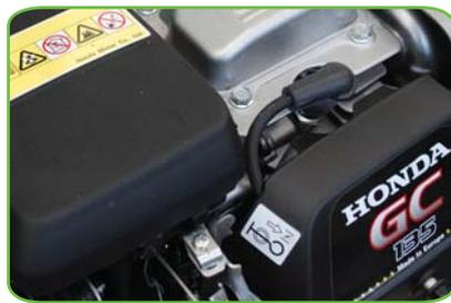
Disponibile in motorizzazione a benzina. Il motore endotermico è collegato direttamente alle varie funzionalità della macchina. Avviamento motore a strappo.
