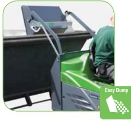
Contenitore rifiuti di grande capacità con sollevamento idraulico fino a 1420 mm di altezza per le operazioni di scarico.
