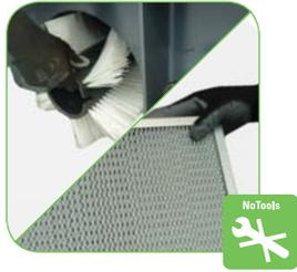
Sostituzione spazzola centrale e filtro senza attrezzi.
