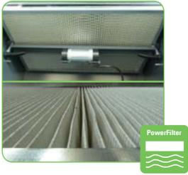
Scuotifiltro con opzione in automatico. Intervallo scuotifiltro programmabile tramite scheda elettronica su versioni a batteria e Dual Power.
