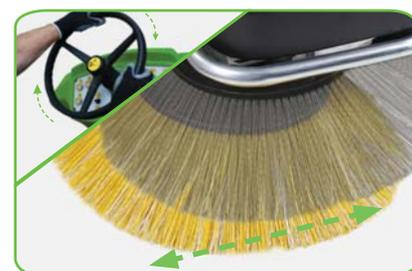
Sistema di rientro automatico delle spazzole laterali in curva, che consente la raccolta di tutti i detriti, evitando residui e scie di sporco.
