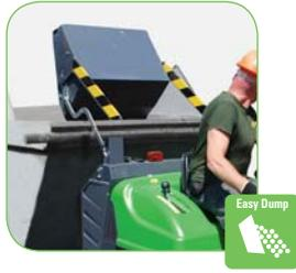
Contenitore rifiuti di grande capacità con sollevamento idraulico fino a 1430 mm di altezza per le operazioni di scarico.
