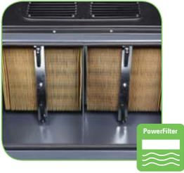
Scuotifiltro con opzione in automatico. Intervallo scuotifiltro programmabile tramite scheda elettronica.
