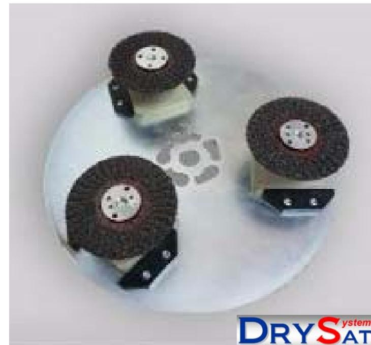
E' un sistema *pratico, efficace ed economico*, utilizzato per sgrossare le superfici in marmo, marmettoni, cemento e granito, ed eliminare solchi profondi, denti, residui di stucco e mastice, utilizzati per la chiusura di buchi e fughe. Viene utilizzato anche per eliminare le parti superficiali deteriorate, aggredite da agenti chimici e/o rese friabili dal tempo, raggiungendo il cosiddetto “*marmo vivo*”.
