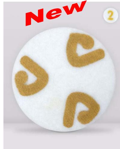
**DISCO LR2** (resine diamantate gialle): disco resino-diamantato a media abrasività che elimina le striature più fini prodotte dal DISCO LR1 lasciando la superficie completamente raffinata e uniforme, senza alcun segno o graffio. Si utilizza con acqua.
